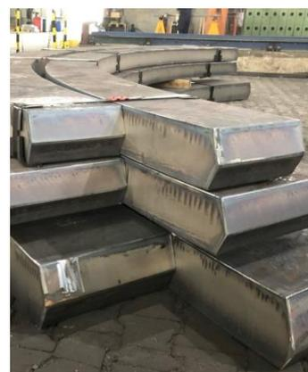
Brennschnitt DILLIMAX 690
