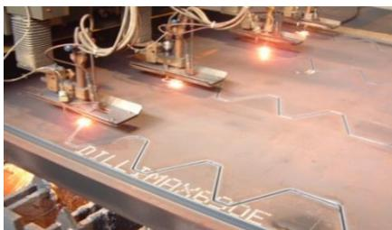
**Brennschnitt DILLIMAX 690 E**
